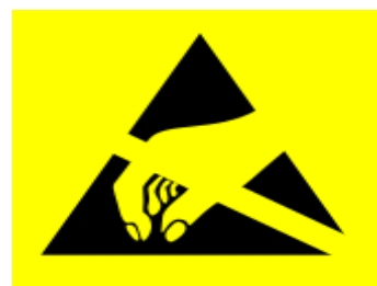
ESD gefährdete Baugruppen (Dieses Logo ist ein Hinweis auf der äußersten Verpackung)
